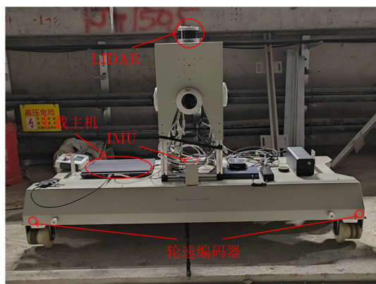
图5 在轨巡检机器人及其传感器布置图
