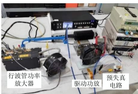
图9 模拟预失真级联TWTA后测试平台
