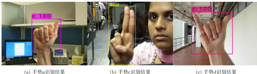
图9 改进YOLOv4-tiny算法手势检测识别结果
