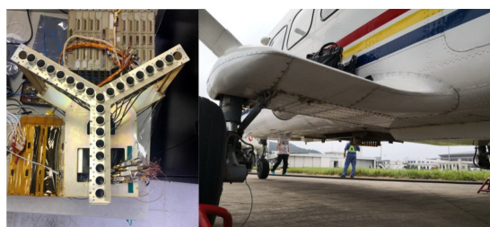
(a) 被动干涉微波无源探测系统 (b) 系统机载实验安装示意图
