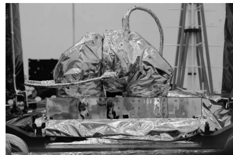
图3 实践二十号卫星激光终端
