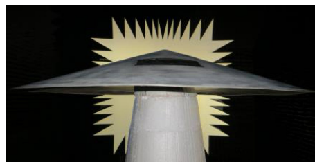
图12 紧缩场微波暗室中的缝隙模型图
