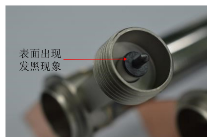
图2 真空柜中存放的高频组件
