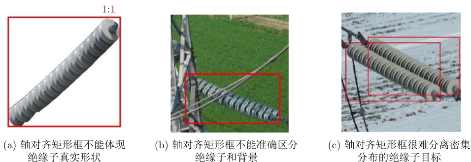
图10 原始SSD轴对齐矩形框缺点
