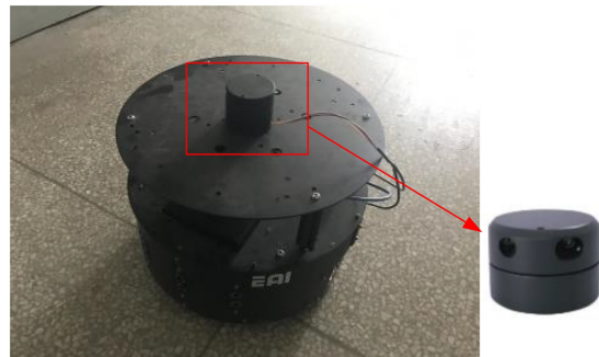
(b) EAI机器人及其搭载的2D激光雷达
