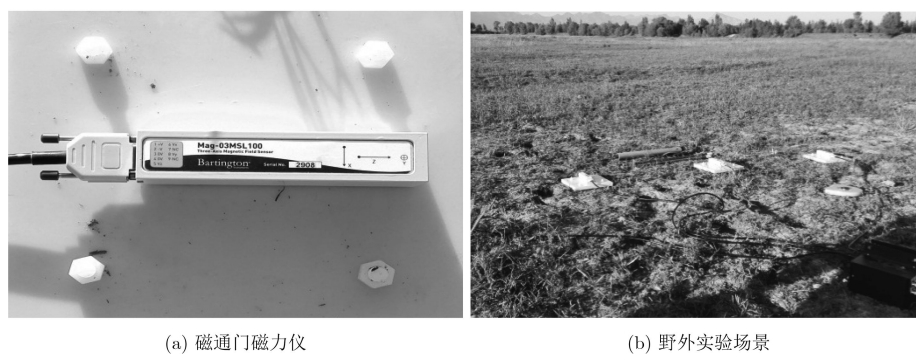
图9 磁场传感器与野外实验场景
