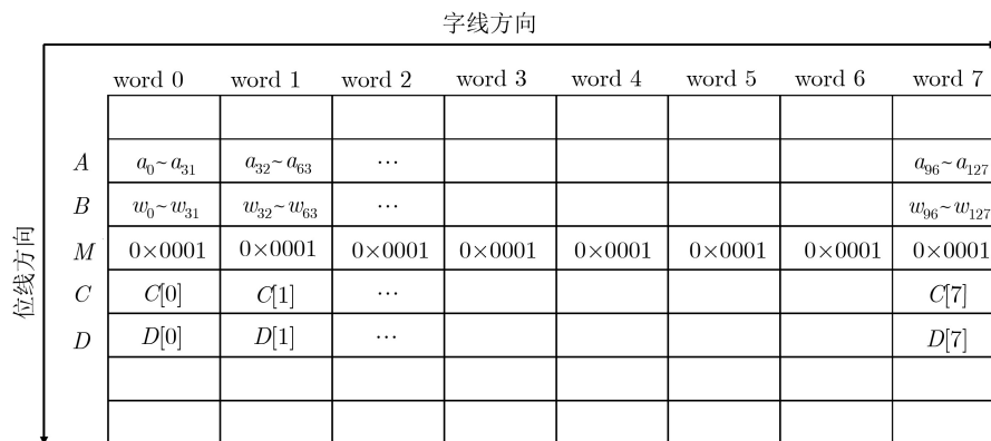
图8 二值神经网络中激活和权重在IMC-SRAM中的映射
