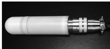
图3 MEMS工频电场测量探头
