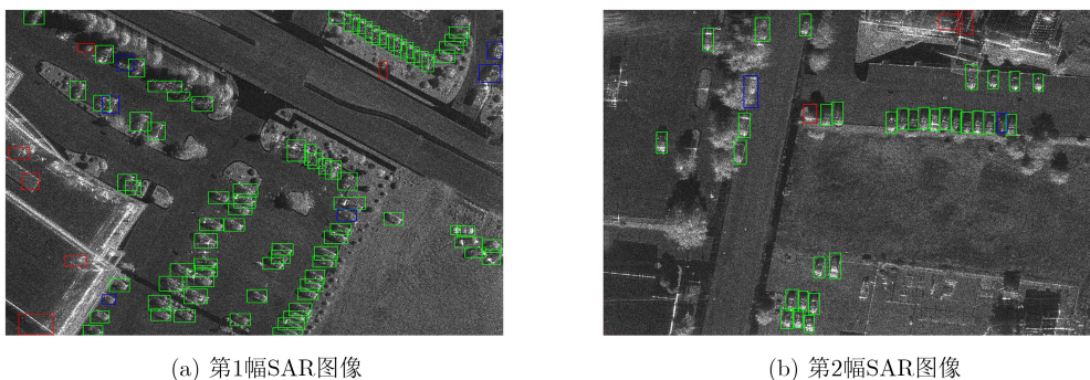
图 11 FARADSAR数据集：Faster R-CNN-少部分切片级标记的检测结果
