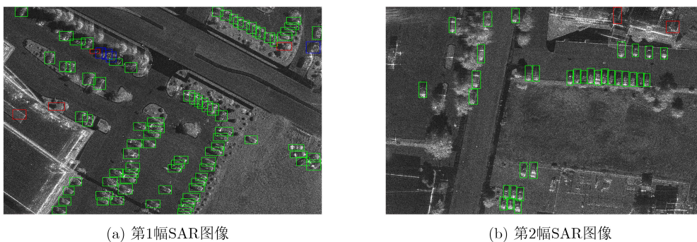
图 12 FARADSAR数据集：Faster R-CNN-全部切片级标记的检测结果
