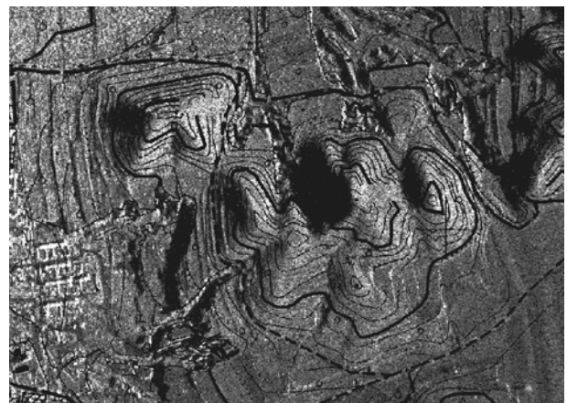
图 6 地形图和雷达正射影像图的叠加
