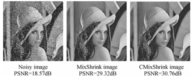
图3 基于 DWT 和 CWT 混合模型的图像降噪效果
