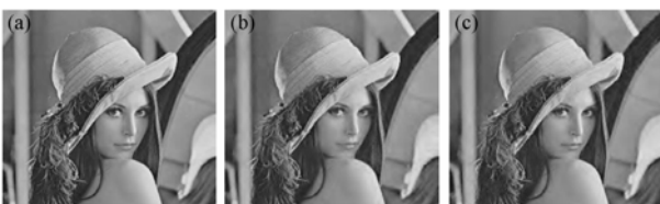
图4 本系统对Lena图像进行仿真的结果(比特率=0.5 bpp) (a) 接收到两个描述(36.25dB) (b) 只接收到第一描述(32.74dB) (c) 只接收到第二描述(32.34dB)
