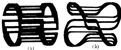
(a) 绕组端耳垂直 z 轴 (b) 绕组端耳与 z 轴倾斜
