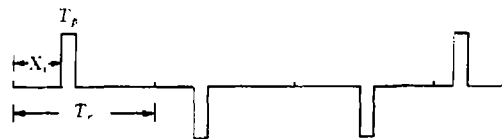
图 1 随机脉位加随机调相脉冲串信号波形
