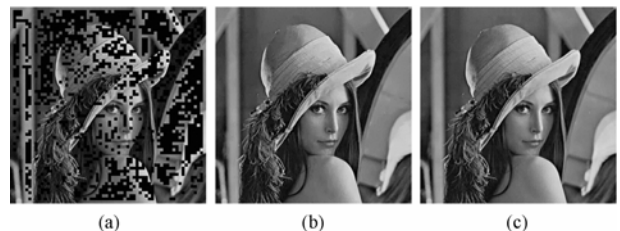
图 5 (a)人为损坏的传输图像 Lena (b)修复解压图像输出 Lena (c)仅应用 JPEG 压缩图像 Lena
