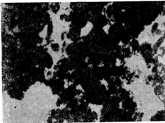
图 2 \text{Al}_2\text{O}_3:\text{Mo} 膜的电子显微镜照片 (膜厚 1000 \text{ \AA} , 5000\times )
