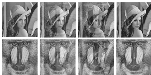
图3 自然梯度法和本文方法进行图像分离的比较 (a) 源图像 (b) 混合图像 (c) 自然梯度分离图像 (d) 本文方法分离图像
