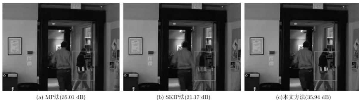
图4 “Exit”序列次核心帧(第30帧)丢失后经不同算法修复后的主观质量图
