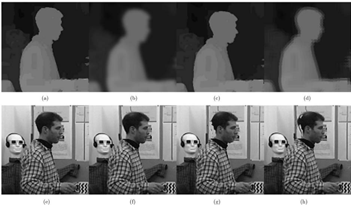
图7 Book_arrival深度图及生成的虚拟视((a),(b),(c),(d)分别表示原始、模糊失真、扭曲失真和碎片失真的深度图; (e),(f),(g),(h)分别为与(a),(b),(c),(d)对应的合成视图)
