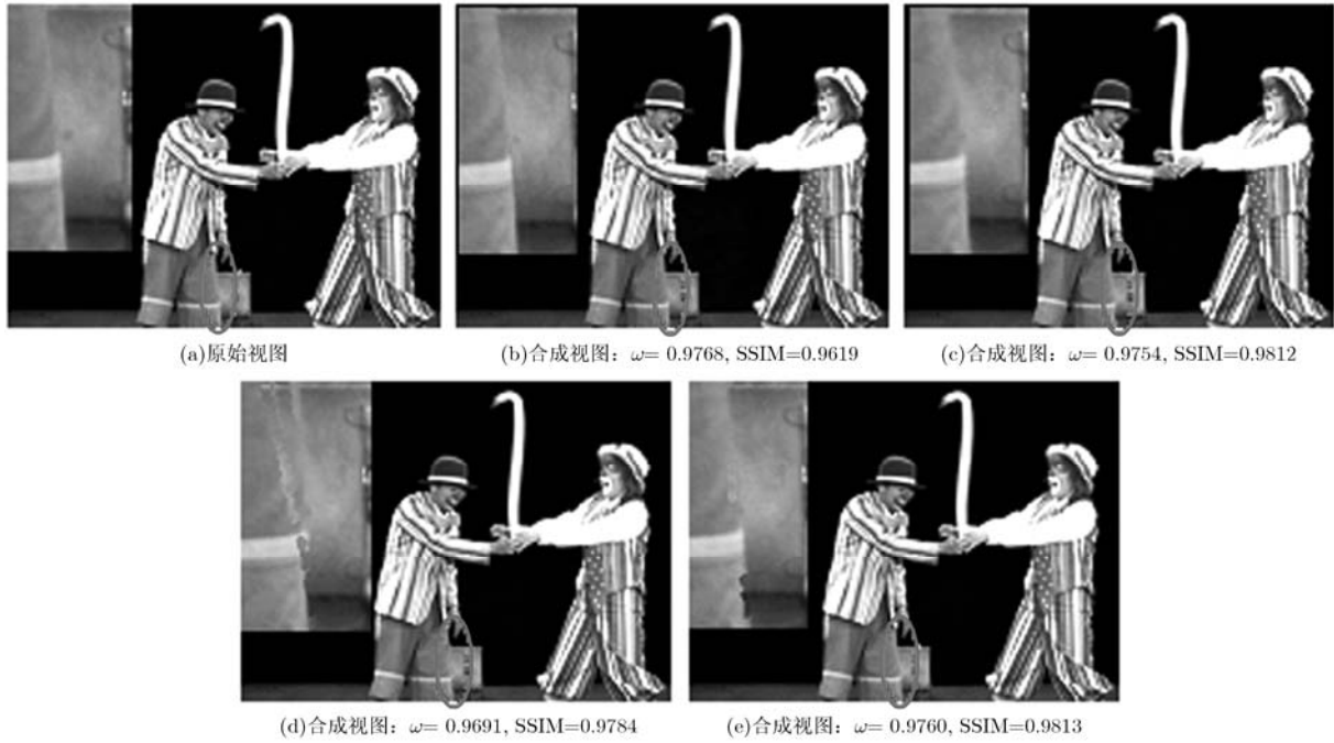
图 5 用本文方法与 SSIM 对虚拟视点的评价结果(Champagne 序列第 38 个视点的第 300 帧)
