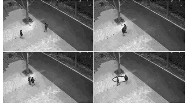
图 9 Camshift 算法跟踪效果图(自左向右,自上向下对应帧 131, 193, 215, 238)
