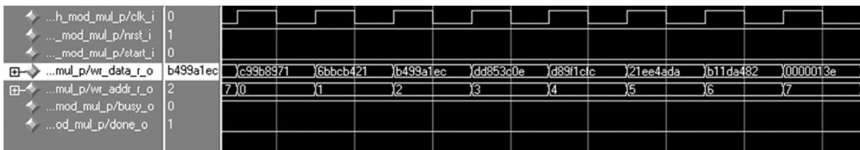
图 5 GF(P)上模乘运算仿真波形
