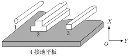
图 1 3+1 多导体传输线系统结构
