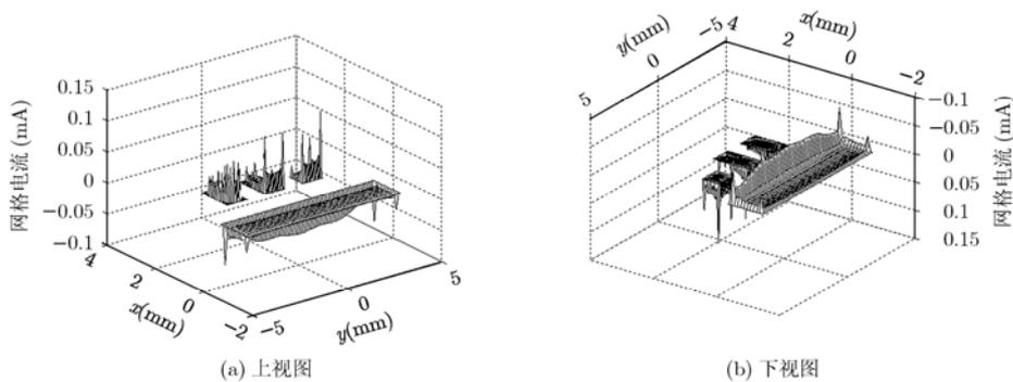
图 4 100 MHz 时 3+1 多导体结构的电流分布示意图
