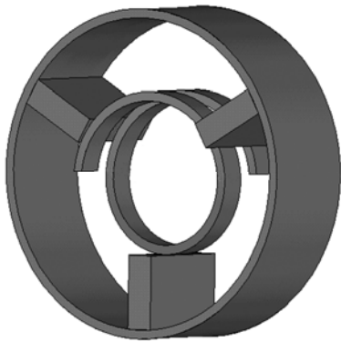
图 2 慢波结构的仿真模型图
