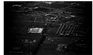
图 5 导向矢量改进后 SAR 成像结果
