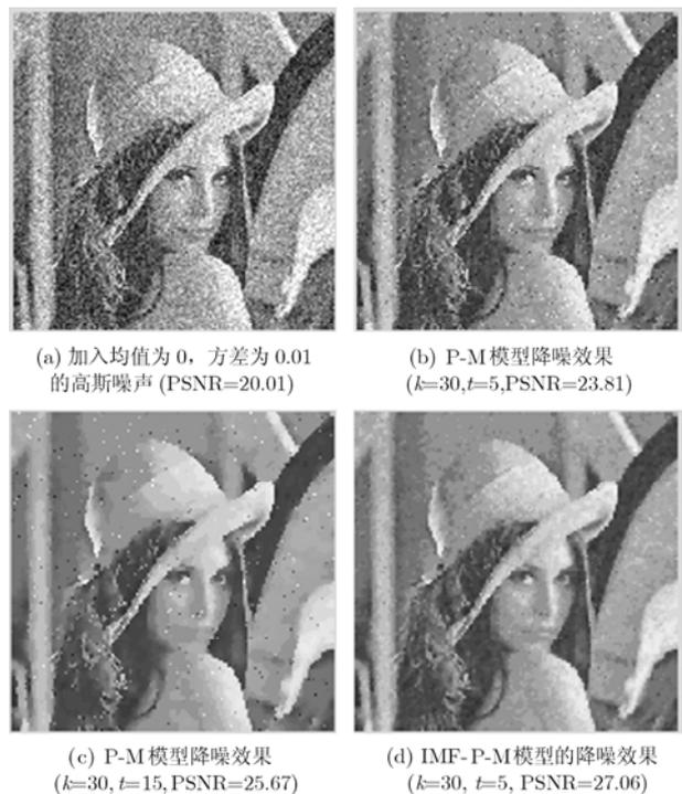
图 3 混有高斯噪声的图像的降噪效果
