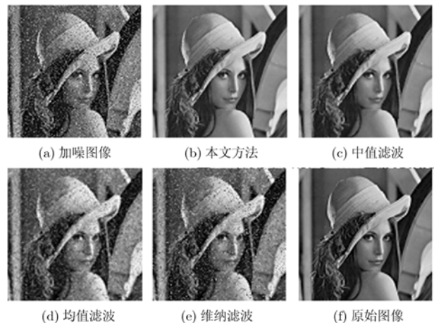
图 1 采用不同方法对 Lena 图像滤波结果的比较
