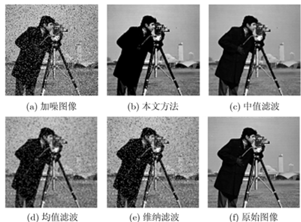
图 2 采用不同方法对 Cameraman 图像滤波结果的比较
