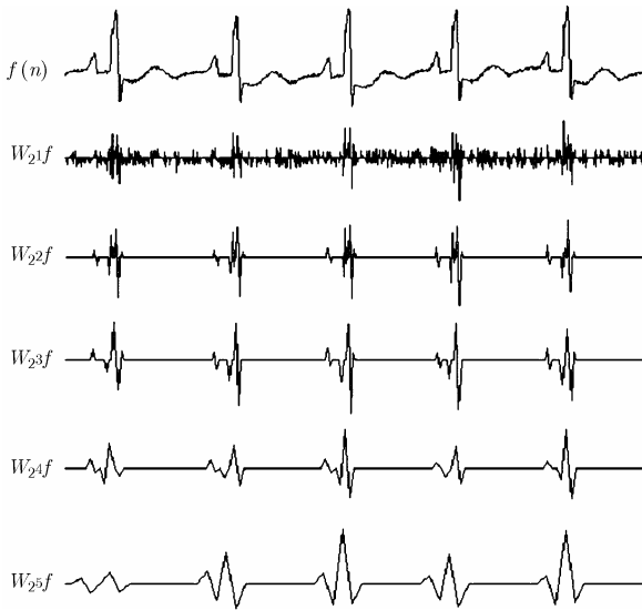
图2 对心电信号进行5个尺度的小波变换模极大值结果
