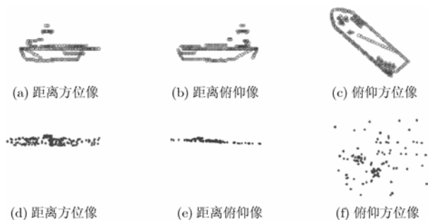
图 5 目标散射点模型和对回波未作杂波抑制处理时的三维像
