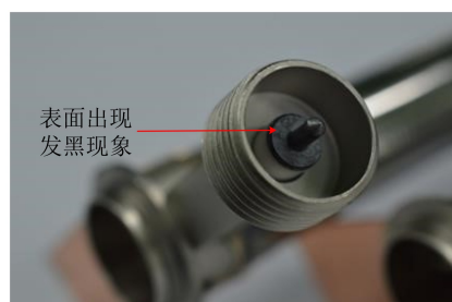
图2 真空柜中存放的高频组件
