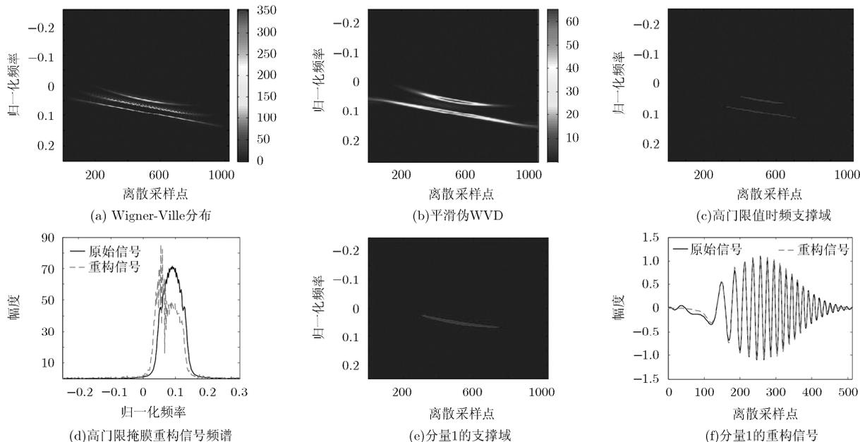
图 3 基于时频平面滑窗掩膜的多分量信号高效重构方法
