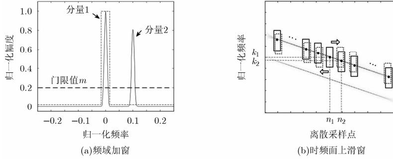
图 1 基于时频面滑窗的动态门限设置方法
