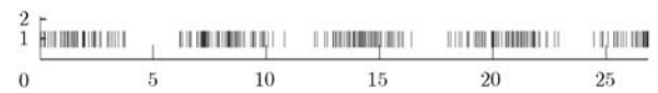
图 4 泊松强度 \lambda(t) = 10\sin(t) + 10 产生的一个长度为 300 个 ISI 的 spike train
