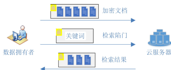
图1 SSE方案系统模型
