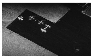
图7 获取的W波段SAR影像2(运5飞机影像)
